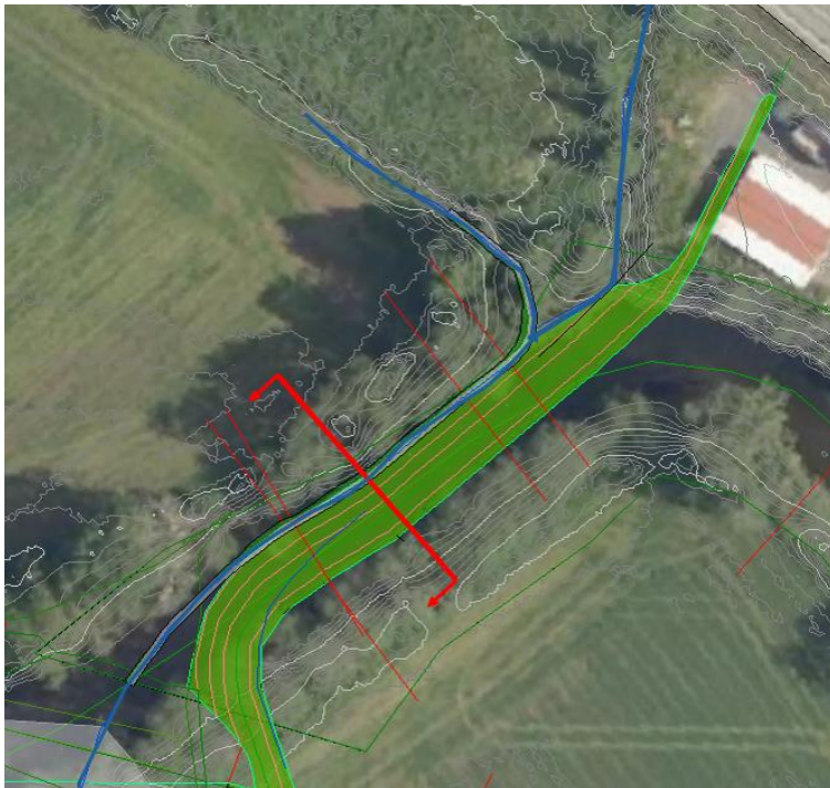
Figur 28: Avledning bekker langs nordside av oppfylling. Bekkene er markert i blått, og oppfylling i grønt. Profil 63 markert med rød snittpil.
